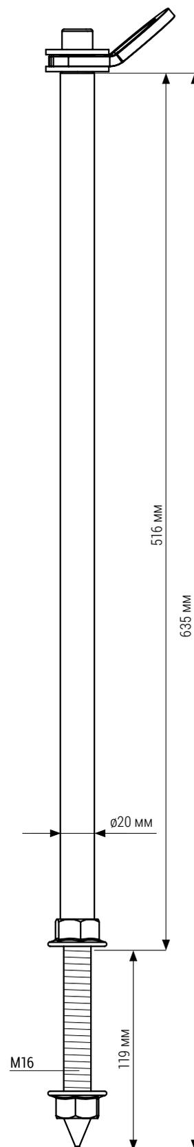
Анкерный столбик отвечает норме EN795:2012 класс А и документу CEN/TS/16415:2013. Статическая прочность мин. 14 кН. Предназначен для одновременной защиты трех пользователей. Выполнен из нержавеющей стали, глубина крепления в бетоне 12 см.
